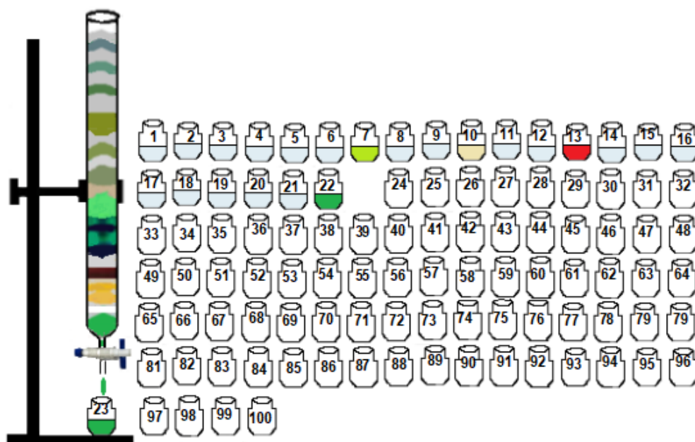
Figura 14.31 – Eluição de coluna preparativa com coleta de frações
