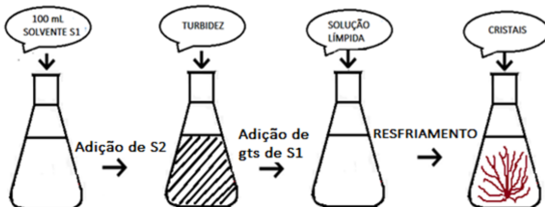
Figura 9.7 – Cristalização com um par de solventes
