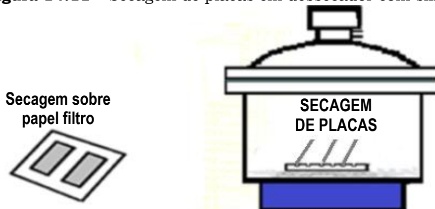
Figura 14.11 – Secagem de placas em dessecador com sílica
