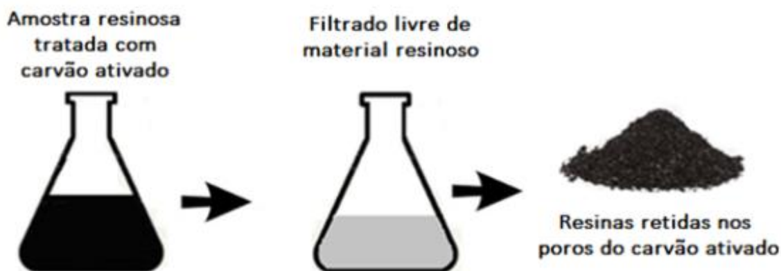
Figura 9.14 – Tratamento de cristais impuros com carvão ativado
