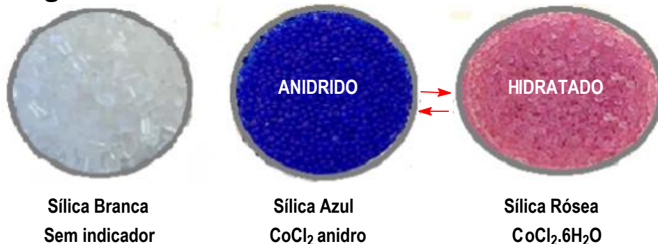
Figura 10.2 – Sílica sem indicador e sílica com indicador
