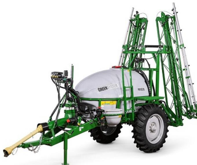
Figura 6: Pulverizador de barras de arrasto.
