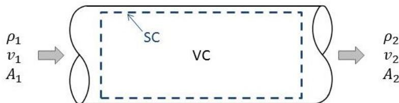
Figura 20: Volume de controle fixo em trecho da mangueira.
