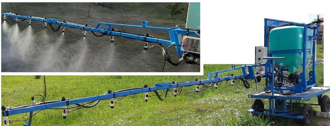
Figura 28: Testes do protótipo, acionamento via motor elétrico.
