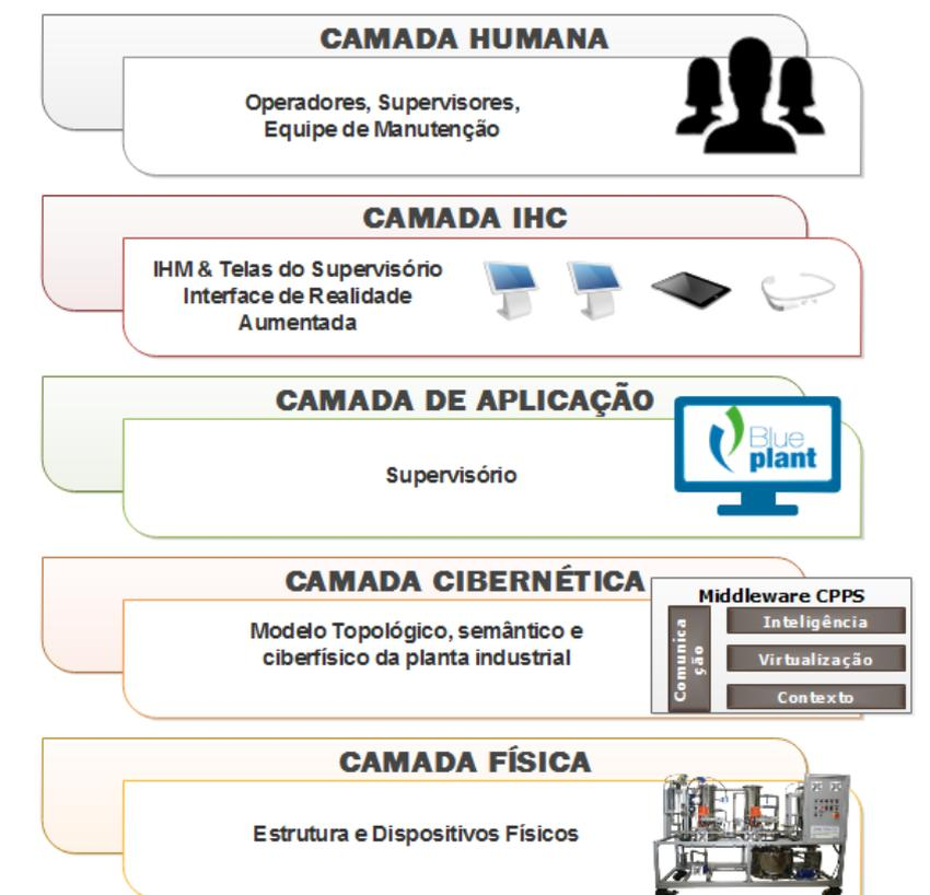
Figura 55: Arquitetura de Integração Vertical - Camadas
