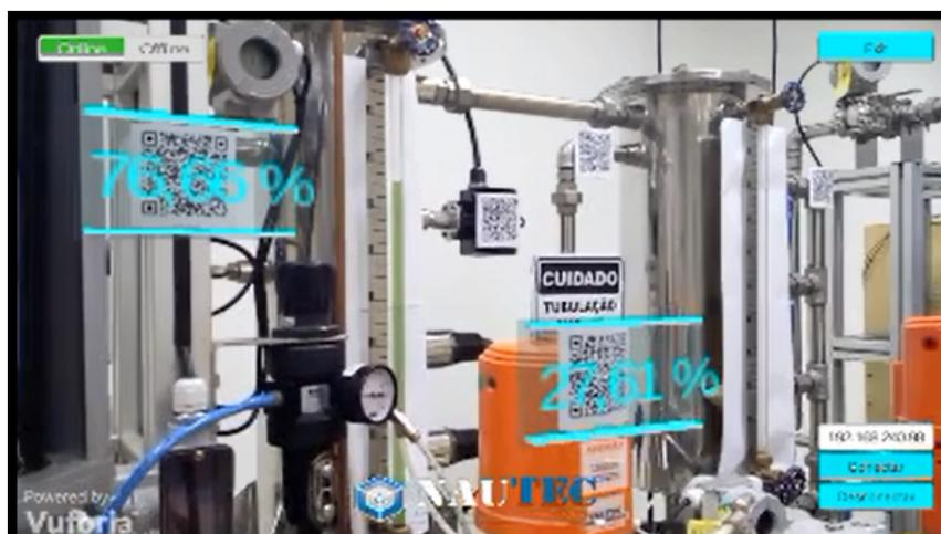
Figura 49: Displays virtuais apresentando informações no ambiente físico
