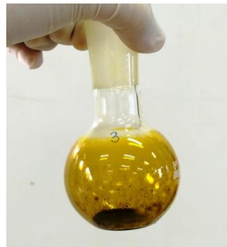
Figura 6A – Biodiesel extraído do experimento com microalga Spirulina sp LEB 18 cultivada em fotobiorreator tubular horizontal equipado com air-lift , meio Zarrowk utilizando CO 2 (10% v/v) como fonte de carbono e redução da fonte nitrogenada (KNO 3 ) em 50%.
