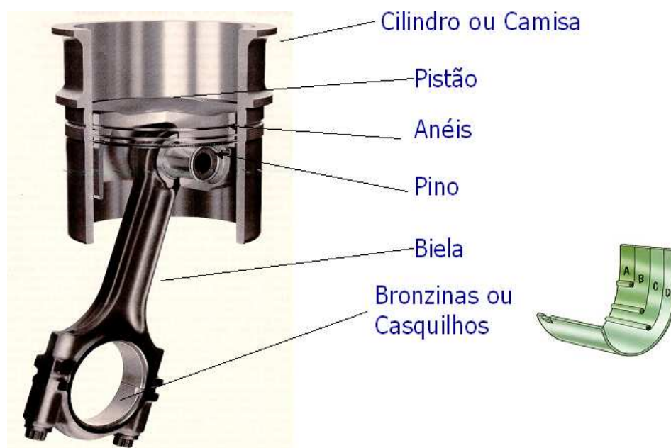
Figura 2.6 – Principais componentes de motores sujeitos a desgaste evidenciado pela análise do lubrificante
