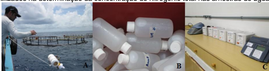
Figura 5.3 – Coleta de amostras de água: (A) Amostragem com garrafa de Niskin; (B) Recipientes utilizados para transportar as amostras; e (C) Kits e aparelhos utilizados na determinação da concentração de nitrogênio total nas amostras de água.
