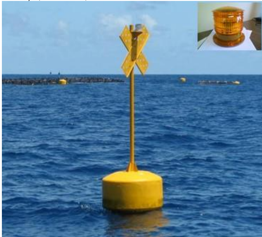
Figura 3.4 – Boia de sinalização na cor amarela com marca de tope em forma de “X” (defletor de radar) e, no detalhe, baliza luminosa com alcance de duas milhas náuticas
