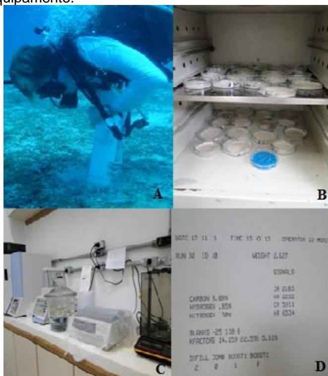
Figura 5.4 – Coleta das amostras de sedimentos: (A) Mergulhador coletando amostra de sedimento com auxílio de corer de PVC; (B) Amostras de sedimento secando em estufa; (C) Analisador elementar CHNS/O; e (D) Saída dos resultados da análise no equipamento.
