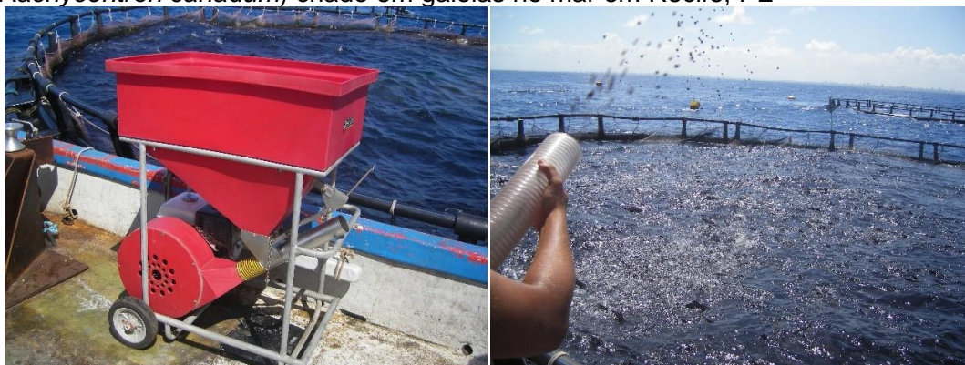
Figura 3.17 – Alimentador semiautomático tipo “canhão” com motor a gasolina e rendimento de cerca de 60 kg.min -1 sendo utilizado na alimentação de beijupirá ( Rachycentron canadum ) criado em gaiolas no mar em Recife, PE
