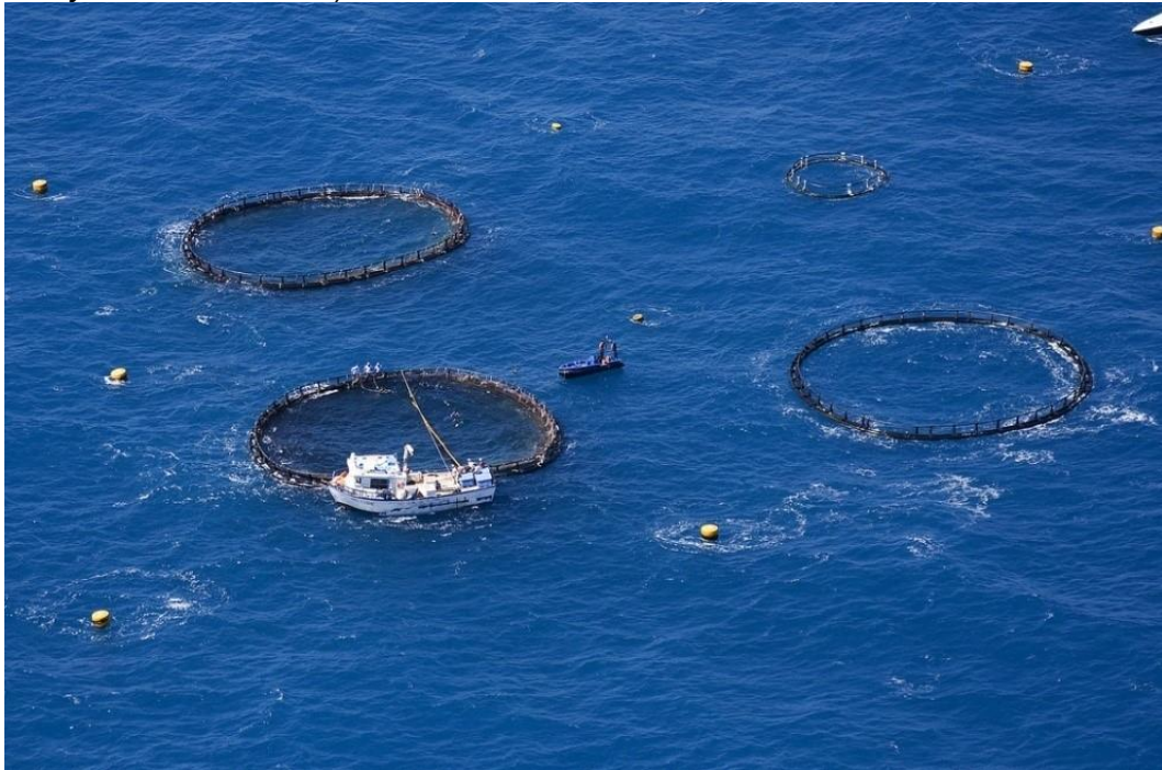
Figura 3.1 – Gaiolas (tanques-rede) flutuantes de polietileno de alta densidade – PEAD com volume unitário de cerca de 5.400 m 3 utilizadas na criação de beijupirá ( Rachycentron canadum ) em mar aberto em Recife, PE
