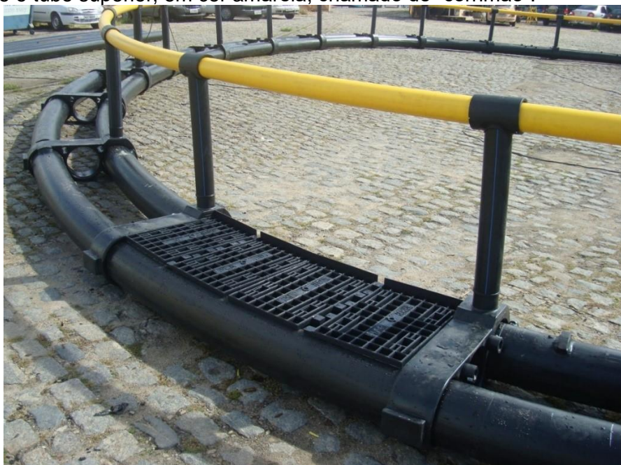
Figura 3.9 – Plataforma de trabalho acoplada à gaiola (tanque-rede) circular construída com dois tubos concêntricos de polietileno de alta densidade – PEAD. Notem os “brackets”, estruturas em forma de “L” que unem os tubos de PEAD, inclusive o tubo superior, em cor amarela, chamado de “corrimão”.
