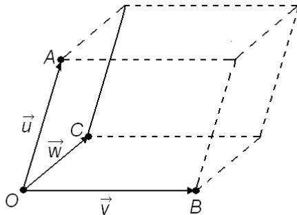
Esse resultado pode ser provado a partir do volume do paralelepípedo (área da base x altura), onde a área da base é igual ao produto entre  $|\vec{v} \times \vec{w}|$  e a altura que é igual a  $|\vec{u}| \cdot \cos \theta$  e  $\theta$  o ângulo entre os vetores  $\vec{v} \times \vec{w}$  e  $\vec{u}$ .
